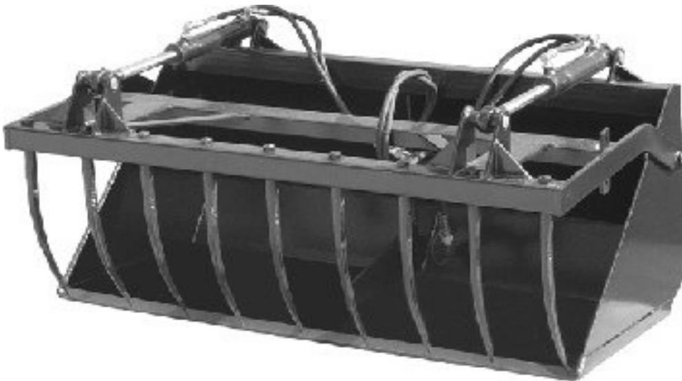
**Euro 8 Aufnahme, kugelgestrahlt und pulverbeschichtet**
