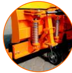
Stützrad mit Gewinde Typ III, nur bei PSV 161 und PSV 181
