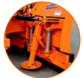
HARDOX-Gleitkufen Typ II, nur bei PSV 161 und PSV 181
