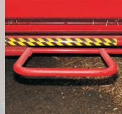
Der Auswerfer rollt die Ballen aus dem Schwenkbereich der hinteren Klappe heraus.
