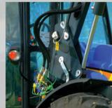
Option bei den Modellen **T241** und **T241/1**: Befestigung von hydraulischen Leitungen mit **MULTILOCK**.
