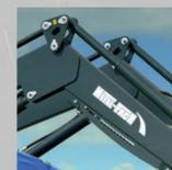
Verdeckte hydraulische Leitungen wirken sich positiv auf Ästhetik und Sicherheit aus.
