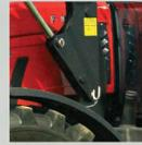
Befestigung am Schlepper mittels Bolzen.
