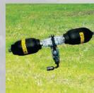
Option in Modellen **T229** und **T229/1**: Hydro-Akku – dämpft Schwingungen und verbessert den Arbeitskomfort.
