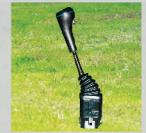
Steuerung über Joystick / 3-Wegeverteiler.
